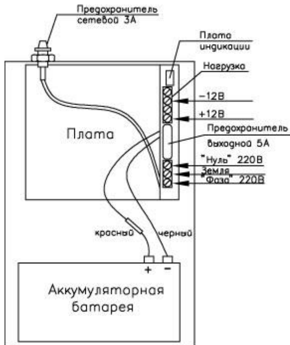
Рис.10 Монтажная схема блока бесперебойного питания FL-1, FL-2 и FL-V (для ББП – 30)
